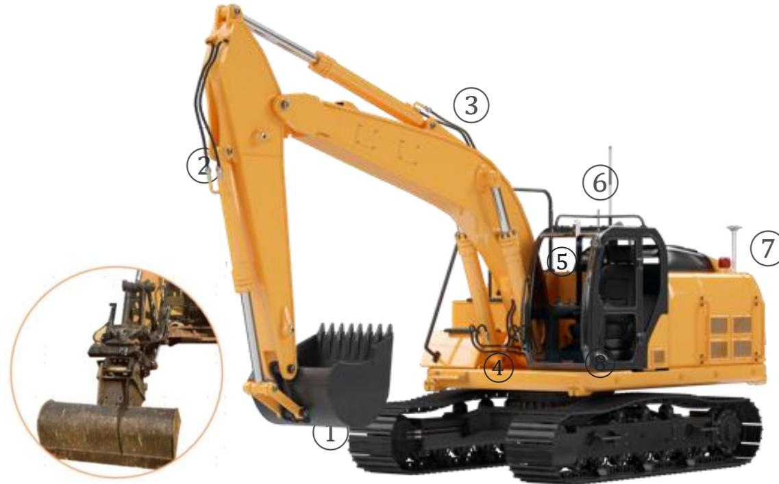
Le système peut être mis à niveau vers la version professionnelle en ajoutant des capteurs pour **godet basculant, tiltrotateur ou double flèche.**
